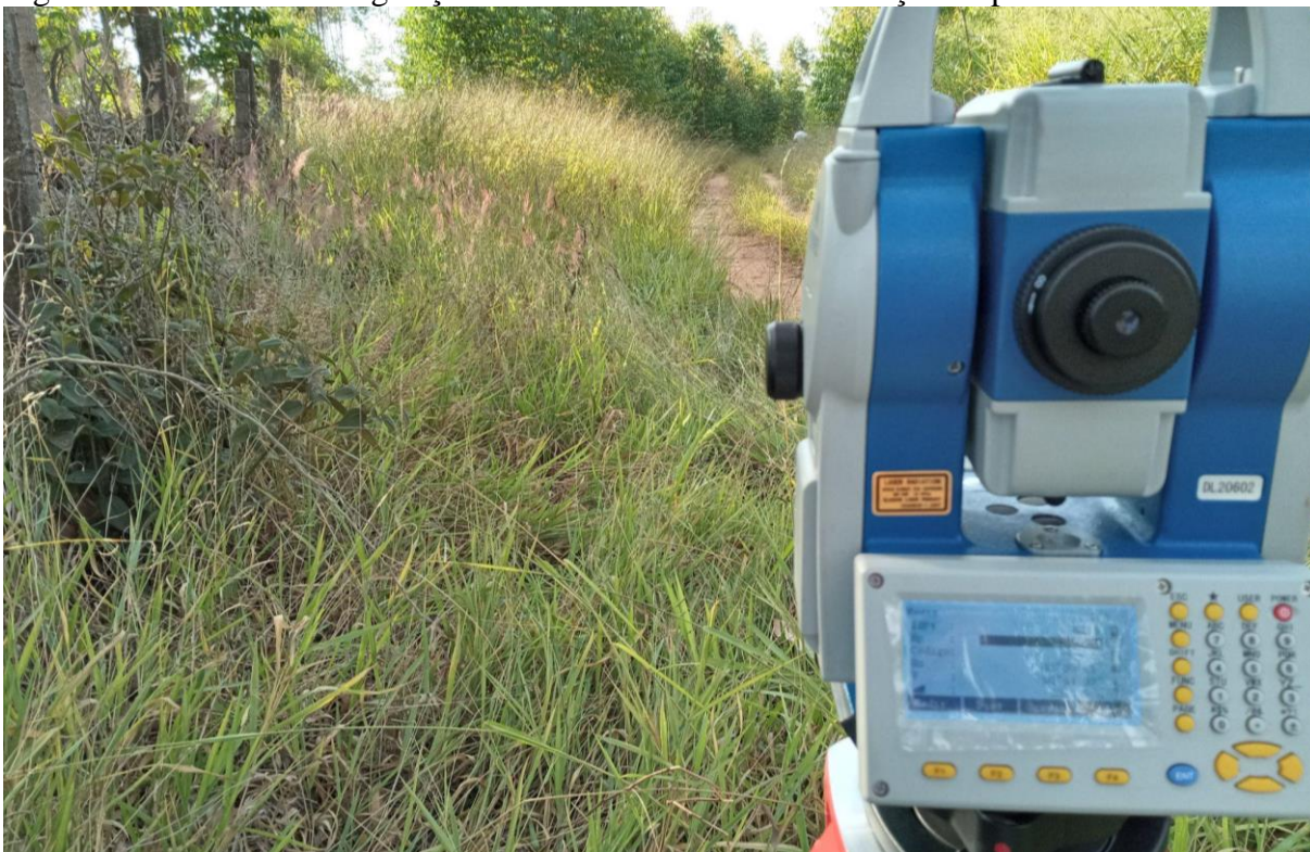
Figura 05 – Ponto E4 - Vegetação alta / dificuldade de visualização de pontos.
