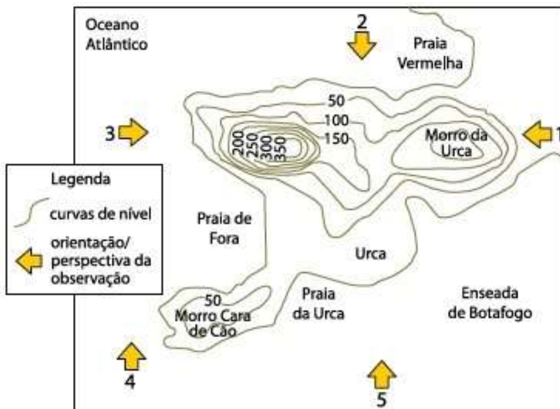
Figura 9: Representação altimétrica por curvas de nível
